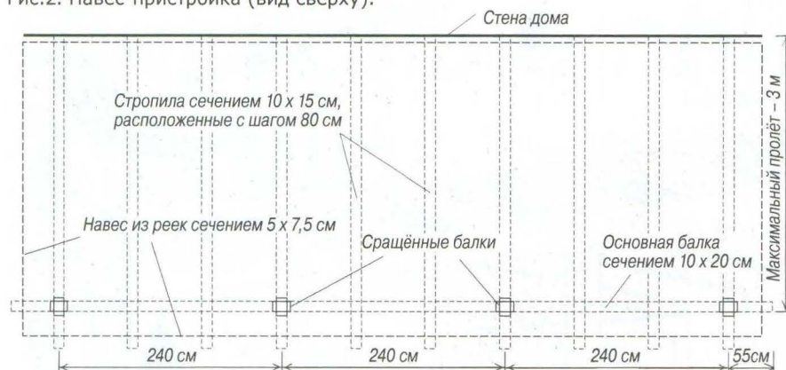
Рис.2. Навес-пристройка (вид сверху).
