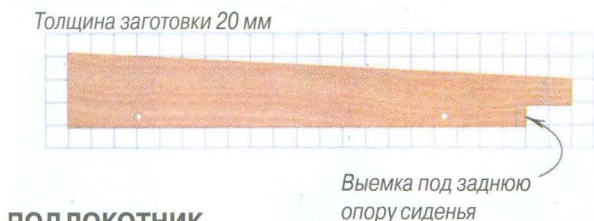
Рис. 2. Шаблоны для изготовления деталей качелей.
