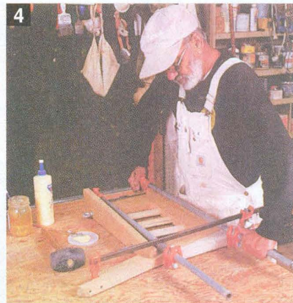
Детали боковин при склеивании зажимают струбцинами.
